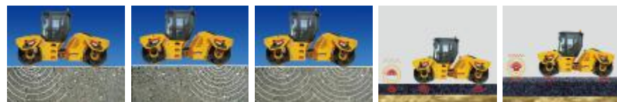
前轮振动 后轮振动 前后同时轮振动 低频高幅，厚沥青层压实 高频低幅，薄沥青层压实
