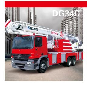
德国奔驰Actros3344底盘,比功率>10,车辆加速性能高;3节多边形伸缩臂+1节折叠臂,内置式液压管路电缆输送系统,上装轻便,伸缩顺畅,管线更安全;4.7吨水的消防液罐,美国大力PSP1500型水泵,罐顶设置消防炮,平台吊重0.4吨,基本臂吊重2吨,半边作业工况。
