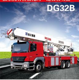
德国AXOR2628底盘; 3节伸缩臂+1节折叠臂结构; 配置国产消防水泵; 工作平台最大负载400kg, 工作平台上预留救生通道, 配置集中润滑系统和空气呼吸系统; 基于CAN总线的PLC控制技术, 可靠实现对多工况的切换和工作范围限定, 智能化的一键展收功能。
